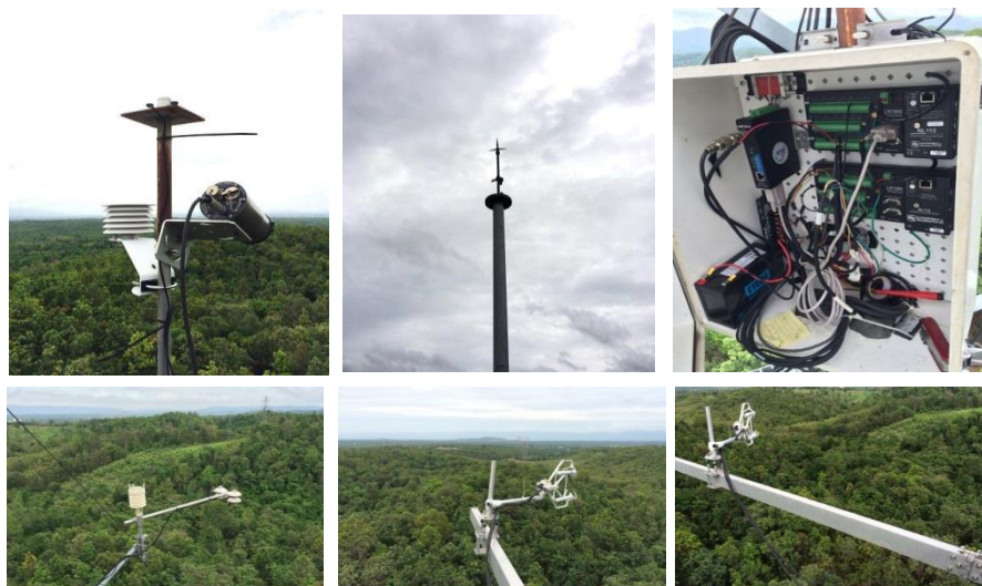
ภาพประกอบที่ 1 อุปกรณ์การตรวจวัดแบบถาวรบนหอคอยในพื้นที่ระบบนิเวศป่าเต็งรัง ที่มา: การลงภาคสนามโดยการอนุเคราะห์จากวิทยาลัยพลังงานและสิ่งแวดล้อม มหาวิทยาลัยพะเยา
